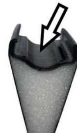
Seguidamente, avanza paso a paso a lo largo de toda la llanta en dirección de la válvula, puesto que de esta manera tienes el máximo lugar en la garganta. En su caso, debes insertar el final del talón en la garganta haciendo palanca con un desmontable Lightweight. Observa la advertencia del punto 3.c.
