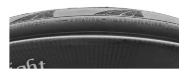
Beginne an der Oberseite des Laufrades langsam den Reifenwulst über das Felgenhorn in das Tiefbett zu drücken (tiefste Stelle in der Mitte des Felgenbetts).
